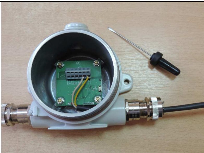
Рис.Г.3 – Коробка ККВ14 с кабелем (кабель показан для примера)
